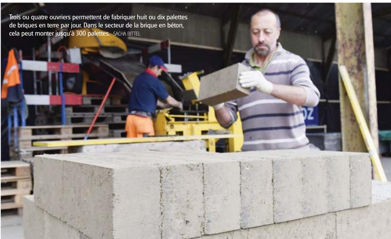
Trois ou quatre ouvriers permettent de fabriquer huit ou dix palettes de briques en terre par jour. Dans le secteur de la brique en béton, cela peut monter jusqu'à 300 palettes. SACHA BITTEL
